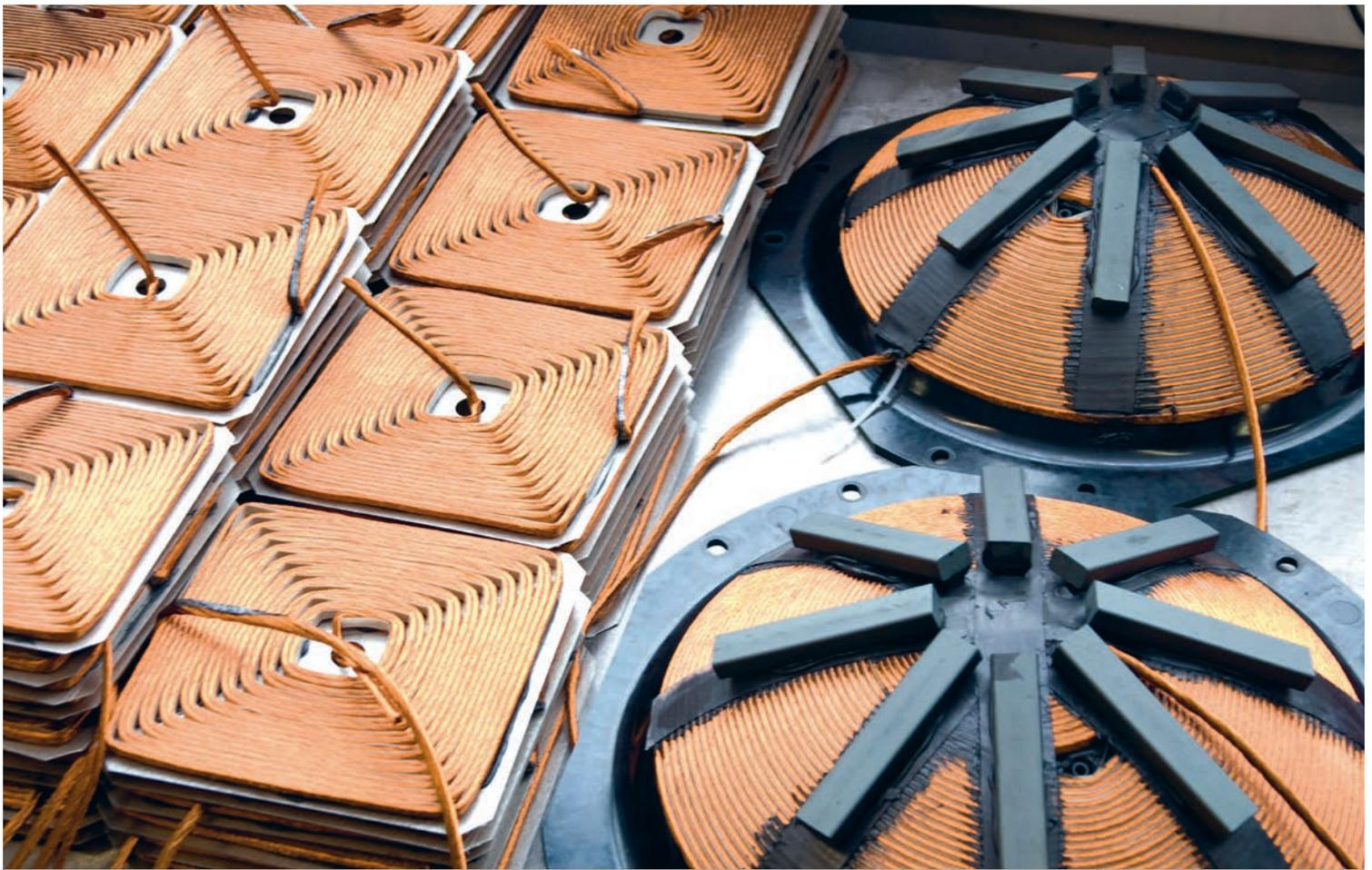
Die von MENU SYSTEM entwickelte und patentierte Induktionstechnologie besteht durch eine besonders lange Lebensdauer, da der Aufbau für optimale Luftkühlung sorgt und der Generator mit genügend Abstand zum Kochfeld platziert ist.
